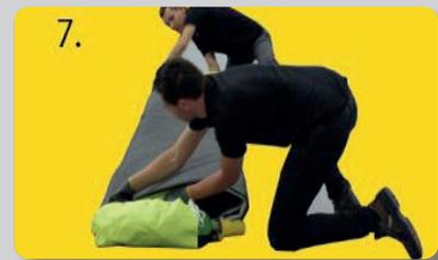
8. Rollen Sie jetzt das Sprungkissen so fest wie möglich zur Druckluftflasche hin auf. Die Breite des gerollten Sprungkissens darf max. 900 mm nicht überschreiten. Eventuell noch im Stützgerüst befindliche Restluft kann über das noch offene Entlüftungsventil entweichen.
