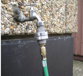
Adattatore per tubo flessibile di prova e di misurazione con tubo flessibile di alimentazione dell'aria
