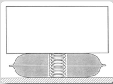
Falls die Hubhöhe bei Verwendung nur eines S.Tec 12 Lifting Bags nicht ausreicht, können bei rutschfester Last **maximal** 2 Kissen übereinander eingesetzt werden. Bei diesem Einsatz addieren sich die jeweiligen Hubhöhen der beiden verwendeten S.Tec 12 Lifting Bags.
