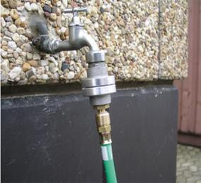
Adaptateur à flexible de contrôle et de mesure avec flexible d'alimentation en air
