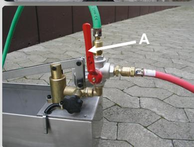
Fermer le clapet antiretour sur le volant à main noir (B). Amener le robinet sphérique (A) de la pompe d'essai à main à l'horizontale et ouvrir le robinet d'arrêt sur le point de prélèvement d'eau. Lorsque le robinet sphérique (A) est positionné à la verticale, l'eau s'écoule jusqu'à la tête de contrôle et de purge.
